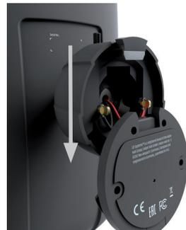
**2** Befestigen Sie die Wandmontageplatte mit dem Klemmblock nach oben zeigend mit Hilfe von geeignetem Befestigungsmaterial sicher an einer ausreichend tragfähigen Wand. Bei unter Putz verlegten Lautsprecherkabeln muss das entsprechende Kabel vor dem Befestigen der Wandmontageplatte durch die zentrale Kabeldurchführung gesteckt werden. Verbinden Sie nun die Lautsprecherkabel mit den entsprechenden Kontakten des Klemmblocks.
