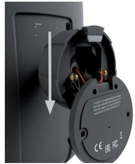
**2** Fije con firmeza la placa empotrada con el bloque de terminales en la parte superior utilizando tornillos apropiados en una pared lo suficientemente capaz de soportar la carga. Para los cables de altavoz tendidos bajo yeso, hay que insertar el cable correspondiente a través del revestimiento de cable central antes de fijar la placa empotrada. Ahora conecte los cables del altavoz a los contactos correspondientes del bloque de terminales.
