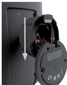
**2** Assurez-vous que le bornier est situé en haut du disque de montage mural et fixez celui-ci fermement sur un mur capable de supporter le poids de l'équipement à l'aide des vis appropriées. Pour les câbles de haut-parleur placés sous un enduit, le câble correspondant doit être inséré dans le passage central de câble avant que le disque de montage mural ne soit fixé au mur. Branchez ensuite les câbles de haut-parleur aux contacts du bornier correspondants.
