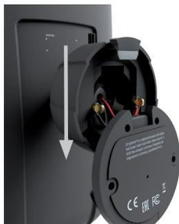
**2** Fissare saldamente la piastra di montaggio a parete con la morsettieria sulla parte superiore utilizzando viti idonee su una parete capace di supportarne il peso. Qualora i cavi dell'altoparlante si trovassero sotto l'intonaco, il cavo corrispondente deve essere inserito attraverso la boccola centrale per cavi prima di fissare la piastra di montaggio a parete. A questo punto collegare i cavi dell'altoparlante ai contatti corrispondenti della morsettieria.
