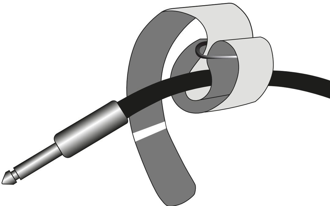
Klett-Kabelbinder werden am Kabelende angebracht. Bitte führen Sie das Klettband, so wie in der Grafik angegeben, um das Kabel herum. Im offenen Zustand kann so der Kabelbinder nicht vom Kabel rutschen.
